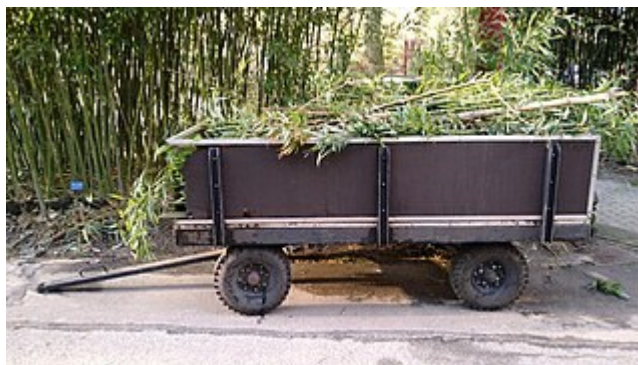
Obrázek 2: Přívěs (vozidlo osvobozené od daně, pokud je dotčený poplatník současně poplatníkem daně ve vztahu k silničnímu tahači). Povšimněte si, že na rozdíl od návěsu má přední kola a je s vozidlem spojen ojí, a nikoliv čepem (neopírá se o vozidlo). Zdroj: Wikimedia Commons 2 .
