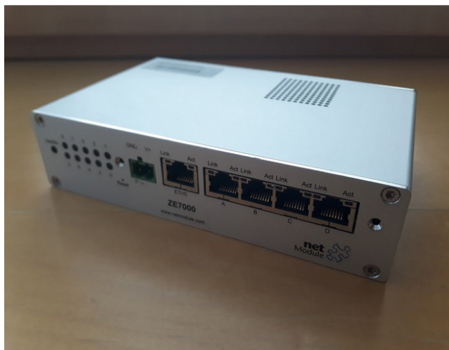
Sonda pro zákonné odposlechy na úrovni aplikačních protokolů
