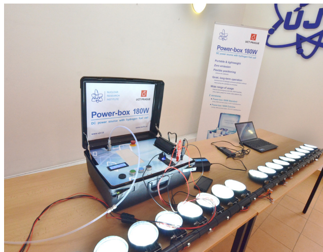
Power-box 180W – ukázka připojení osvětlovací lišty a dalších zařízení
