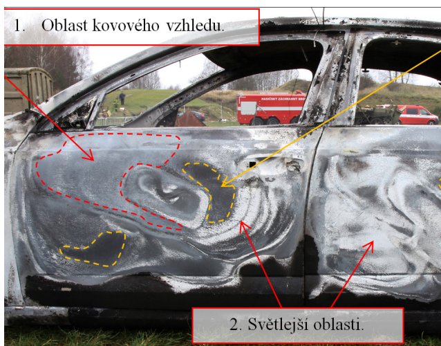
Vozidlo po požáru s vykreslenými stopami, které jsou odlišné svou barvou a ohraničením a na základě těchto charakterů lze snadněji určit rychlost
