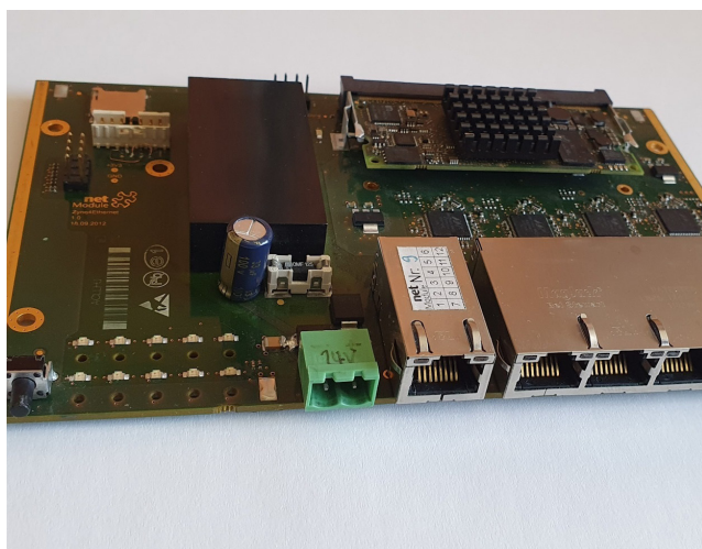
Hardware sondy – vnitřní elektronika sondy s výkonným FPGA čipem
