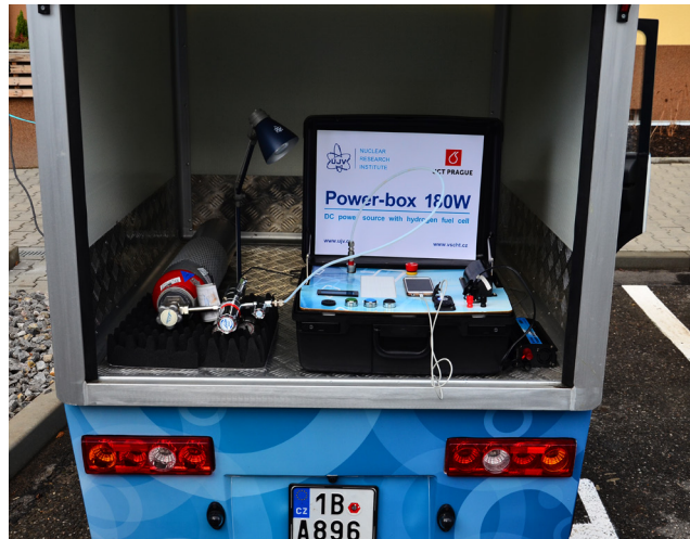
Power-box 180W v elektromobilu HyVan s vodíkovým prodlužovačem dojezdu
