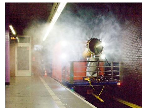
Dekontaminační zařízení DA4 v pražském metru
