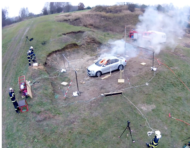
Záznam ze zkoušky v roce 2014, při kterém byl řešen vliv paliva na dynamiku a výkon požáru OA. V rámci těchto zkoušek bylo vytvořeno téma projektu a plánovaný směr výzkumu.
