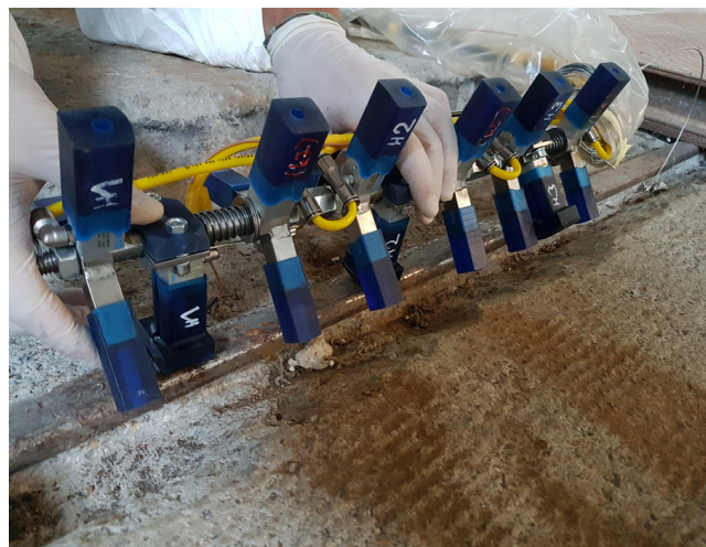
Manipulátor Horymír s otočnými sondami a vysouvacími trny
