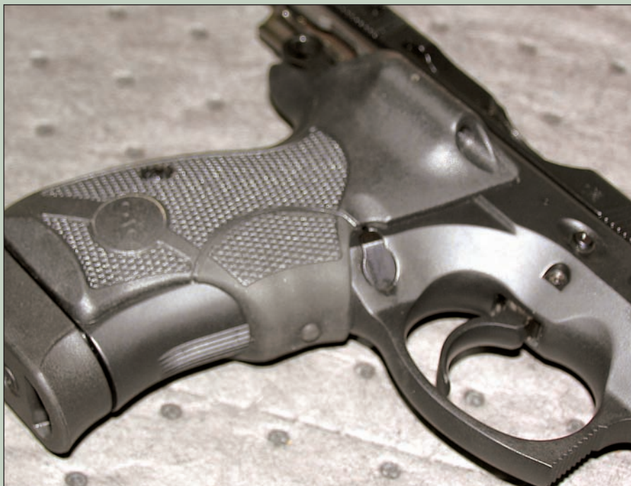
Tlačítko laseru se při normálním úchopu zbraně nachází pod prostředním prstem střelce ruky
