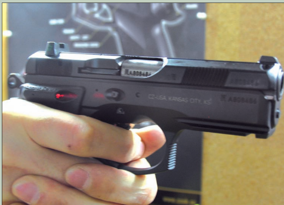
Tlačítko laseru se při normálním úchopu zbraně nachází pod prostředním prstem střelce ruky
