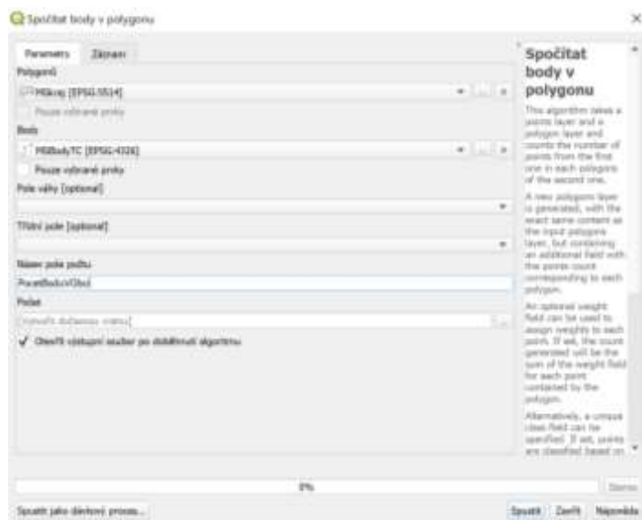
Obrázek 11: Nastavení funkce Spočítat body v polygonu
