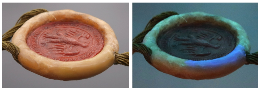
Obr. 7.1 Model poškozené pečeti doplněné pigmentovanou směsí mikrokrytalického vosku Cosmoloid H80 a parafínu v poměru 9:1 v běžném osvětlení (vlevo) a pod UV lampou (vpravo) [11]
