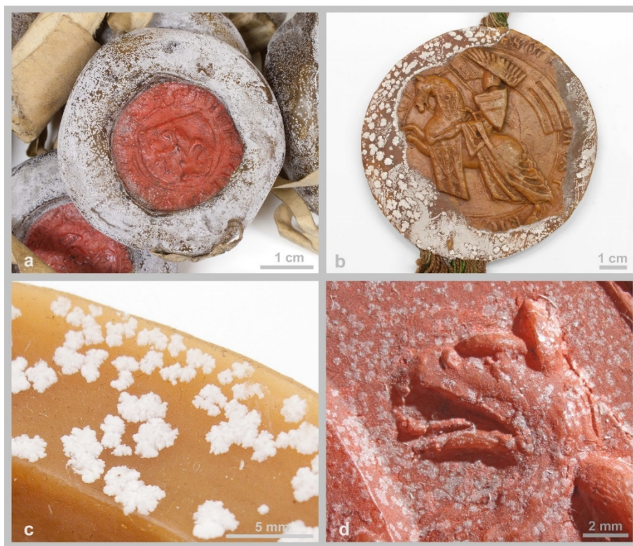
Obr. 6.1 Výkvěty na povrchu voskových pečeti ze 14. století (a), výkvět na povrchu opravy provedené roku 1987 (b), detail krystalů na povrchu opravy z roku 1990 (c) a výkvěty na povrchu červeně zbarveného pečetiho vosku z roku 1867 (d) [12].
